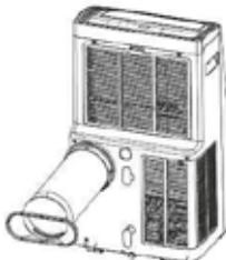
**Paso 6:** Ajuste la longitud del tubo de escape flexible y evite doblarlo. Asegúrese de que esté cerca de una toma de corriente.
