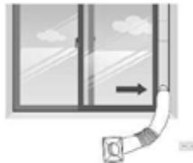
**Stap 5:** Bevestig de slangkoppeling aan de uitlaat van het toestel.
