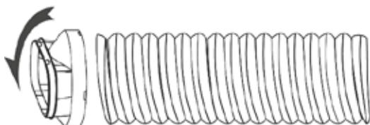
**Paso 3:** Extienda el kit de ventana ajustable por la longitud de su ventana. Conecte el tubo de salida de aire al kit de ventana.
