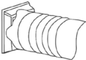
**Schritt 2:** Schließen Sie den Adapter des Fenster-Kits an das andere Ende des Abluftschlauchs an.
