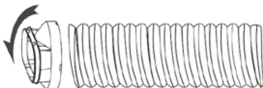
**Stap 3:** Verleng de verstelbare raamkit met de lengte van uw raam. Sluit de luchtafvoerslang aan op de ruitenset.
