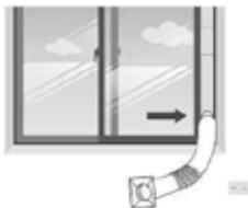
**Paso 5:** Conecte el conector de la manguera a la salida del dispositivo.
