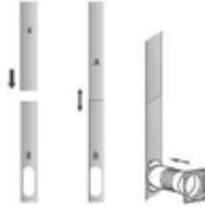
**Stap 4:** Sluit het raam om de kit op zijn plaats te houden. Het wordt aanbevolen om de opening tussen de adapter en de zijkanten van het raam af te dichten voor een maximaal rendement.
