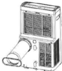
**Schritt 6:** Passen Sie die Länge des flexiblen Abluftschlauchs an und vermeiden Sie Knicke im Schlauch. Achten Sie auf die Nähe zu einer Steckdose.
