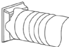
**Étape 2:** Raccordez l'adaptateur de fenêtre à l'autre extrémité du tuyau d'échappement.
