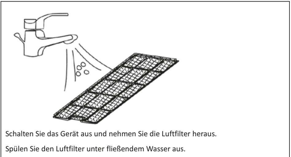
Schalten Sie das Gerät aus und nehmen Sie die Luftfilter heraus.
