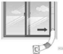
**Étape 5:** Fixez le connecteur du tuyau à la sortie de l'appareil.
