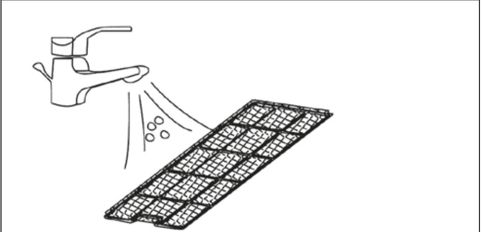
Apague el dispositivo y retire los filtros de aire.
