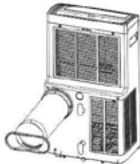
**Stap 6:** Pas de lengte van de flexibele uitlaatslang aan en vermijd knikken in de slang. Zorg ervoor dat hij dicht bij een stopcontact staat.
