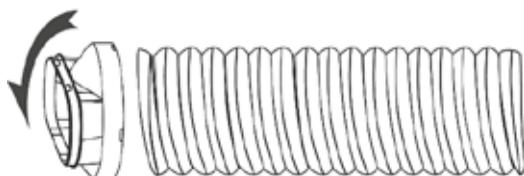
**Étape 3:** Allongez le kit de fenêtre réglable de la longueur de votre fenêtre. Raccordez le tuyau de sortie d'air au kit de fenêtre.
