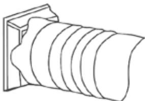
**Paso 2:** Conecte el adaptador de ventana al otro extremo del tubo de escape.
