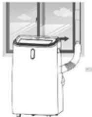
**Étape 7:** Ajustez la grille de la sortie d'air, puis mettez l'appareil en marche.
