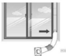
**Schritt 5:** Bringen Sie den Schlauchanschluss am Abluftausgang des Geräts an.
